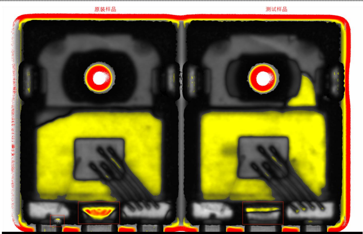
IC-25 兆赫-引线架与塑封料界面(顶视波形图)
