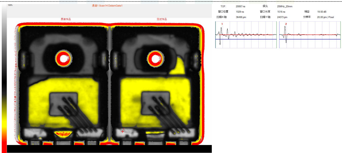
IC-25 兆赫-基板与塑封料界面(顶视图)
